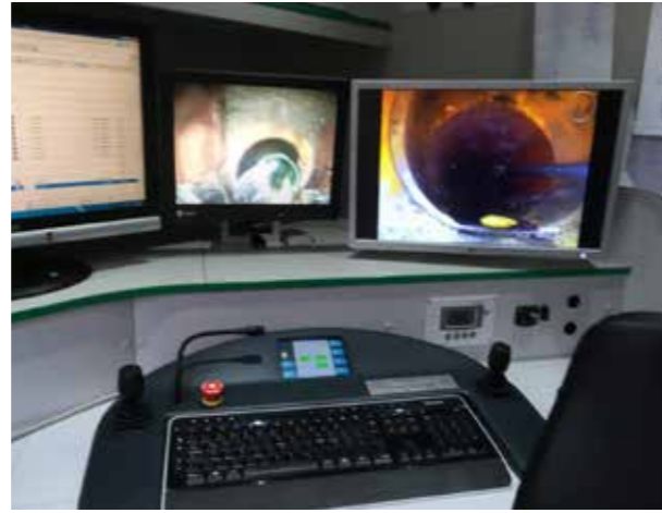
Bild: Führerstand des Kamerawagens
