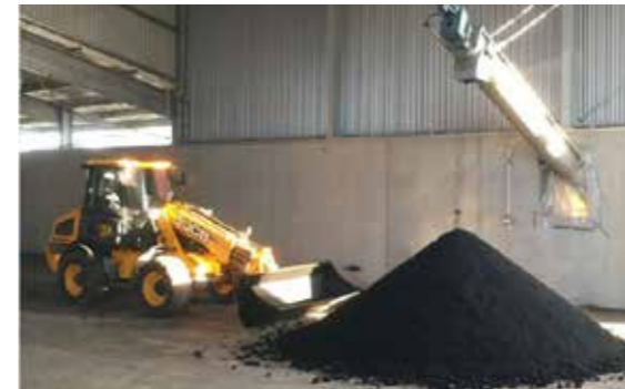
Bild: Erster entwässerter Klärschlamm
